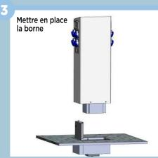
Verrouillage de la borne sur le crochet à l'aide de la poignée
