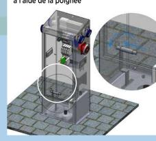
Placer la cloche à l'intérieur de la borne Cloche de protection de la prise Le tampon rentre à l'intérieur de la borne
