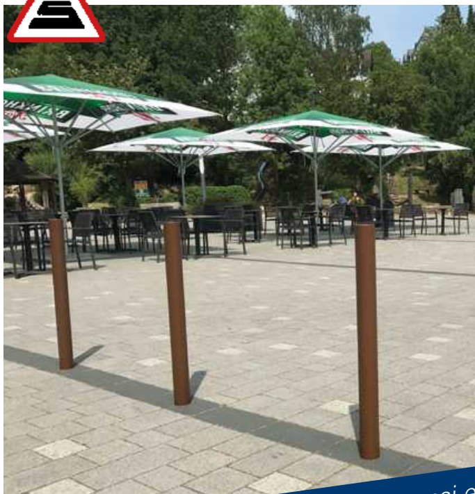
Borne décorative de dissuasion en tube d'acier Ø 76 mm env. 950 mm hors sol, galvanisé à chaud et revêtu
